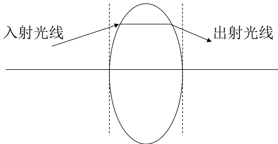
薄透镜的作用 (1) 成像 (2) 傅里叶变换
