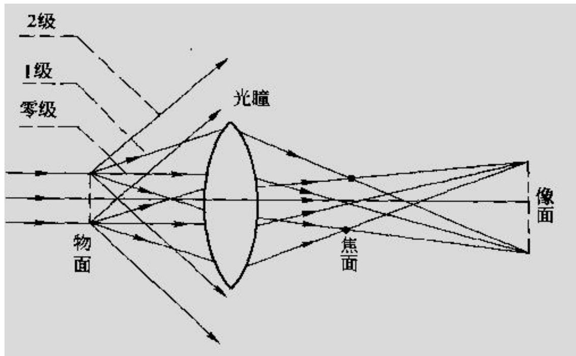
衍射受限相干成像系统对输入的各种频率成分的作用，相当于一个低通滤波器。由此可见，截止频率是检验光学成像系统质量优劣的重要参数之一。
