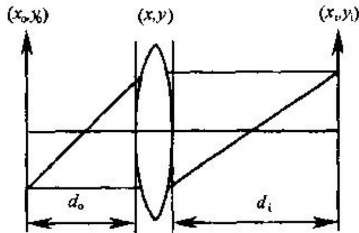
图4.1.1 透镜脉冲响应函数简图
