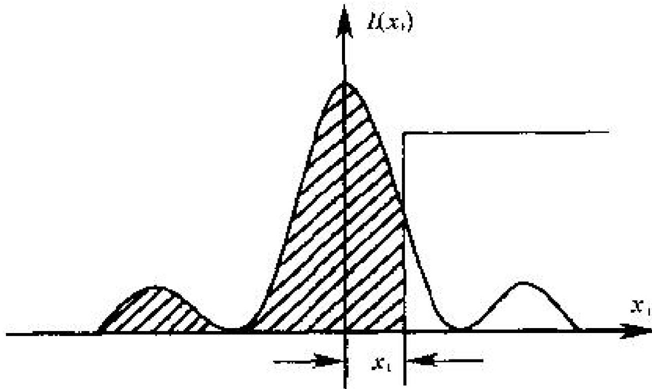
边缘扩散函数  $E(x_i)$  来源于线扩散函数  $L(x_i)$
