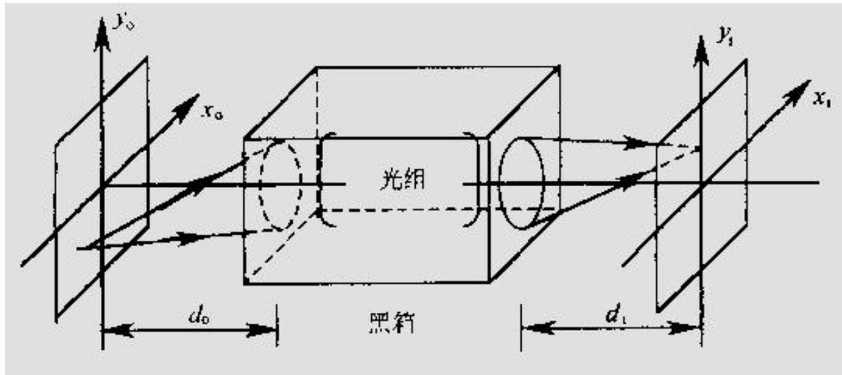
一个成像系统的外部性质可以由入射光瞳或出射光瞳来描述。因此，成像系统可以归结为下列普遍模型：光波由物平面变换到像平面，可以分为3个过程，即光由物平面到入瞳面，再由入瞳面到出瞳面，最后由出瞳面到像平面。
