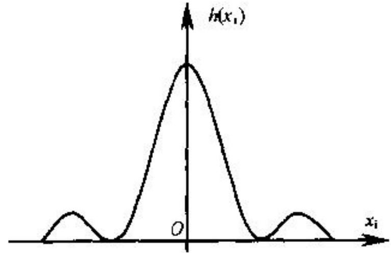
图示代表亮直线的成像情况，这就是实际成像的强度分布，也就是线扩散函数。点扩散函数的曲线形状和线扩散函数的曲线形状是不一样的。线扩散函数由点扩散函数叠加而所。
