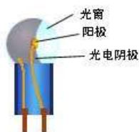
真空光电管构造示意图
